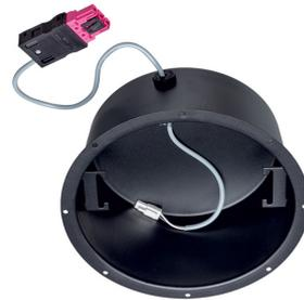
Der 4W starke Deckeneinbau-Lautsprecher ist mit einem 165-mm-Breitbandlautsprecher und einem 100V Übertrager mit 3 Leistungsanpassungen ausgestattet. Das pulverbeschichtete Metallgehäuse in RAL 9010 garantiert dauerhafte Stabilität und makellose Optik.
